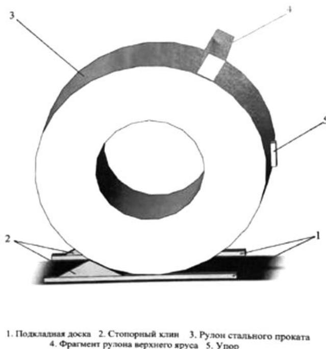
Рис. 2. Имитационная модель для оценки напряженного состояния клиньев
