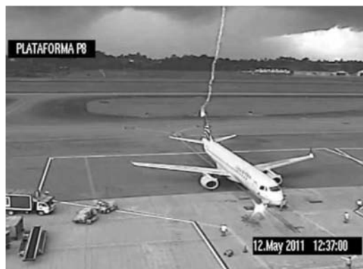
Рис. 14. Разряд одиночной молнии с движением снизу-вверх её электрического заряда, в том числе первоначально с суши (где имеется наибольшая вспышка на русле молнии) на стоянке самолёта по его носовой части, далее течение электрического тока молнии по внешней обшивке стоящего самолёта, затем по его киллю, потом вторичный разряд той же молнии вновь вверх с килля стоящего самолёта по атмосфере с зарядом перезлектронности. См. в Интернете: Удар молнии по самолёту на стоянке - смотрите картинки
